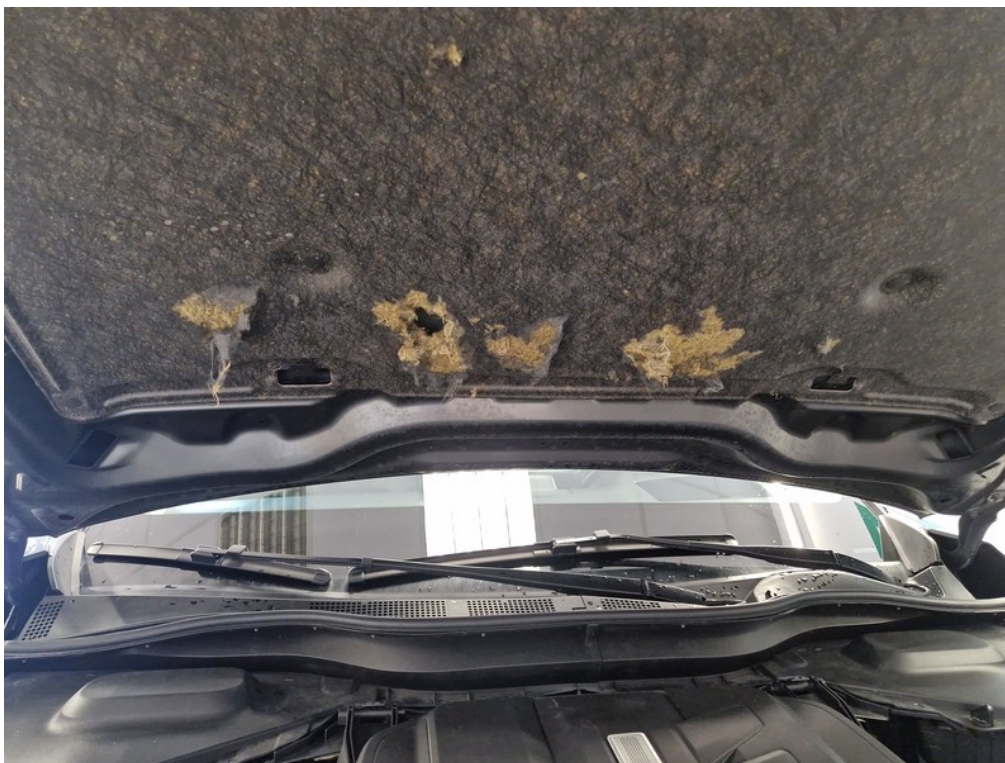
12 Hluková izolácia prednej kapoty - Otvor Umiestnenie: Interiér (vnútorný priestor)
